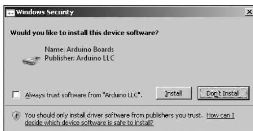
Figura 1.11. Driver encontrado, se procede a la instalación.
